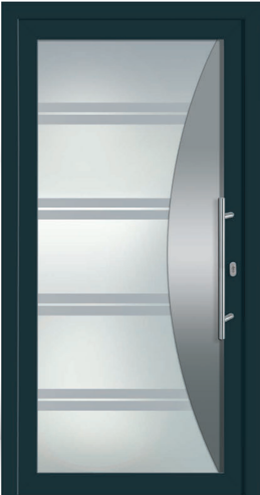
V-473 Ansicht A / DIN rechts G Ganzglasfüllung 3-fach Glas, Ug 1,7 bei 28 mm und Ug 1,1 bei 36 mm bogenförmige Applikation in Edelstahloptik, helle Flächen mattiert, dunkle Streifen Klarglas ■ Griff ZAE 6s, 600 mm | PG 6
