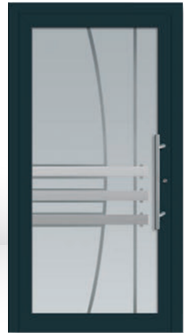
V-476 Ansicht B / DIN rechts G Ganzglasfüllung 3-fach Glas, Ug 1,7 bei 28 mm und Ug 1,1 bei 36 mm helle Flächen mattiert, dunkle Streifen Klarglas, Streifenapplikationen in Edelstahloptik ■ Griff ZAE 6s, 600 mm | PG 6
